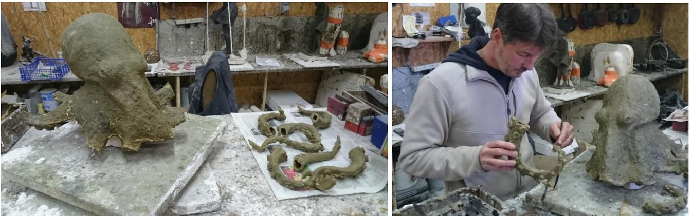
Cette copie en cire sert de référence à la **production de l'œuvre en bronze**, par la technique de la cire perdue. La pièce en cire est entièrement prise dans un coffrage en plâtre, avec des évents en cire pour l'évacuation. Le tout est placé dans un four pour évaporer la cire et laisser place à un vide que le bronze liquide remplacera.
